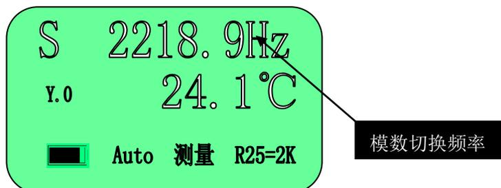
图五 显示频率界面
