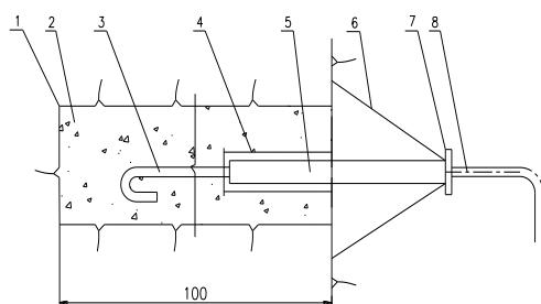
接触缝面测缝计的埋设 (尺寸单位: cm)
