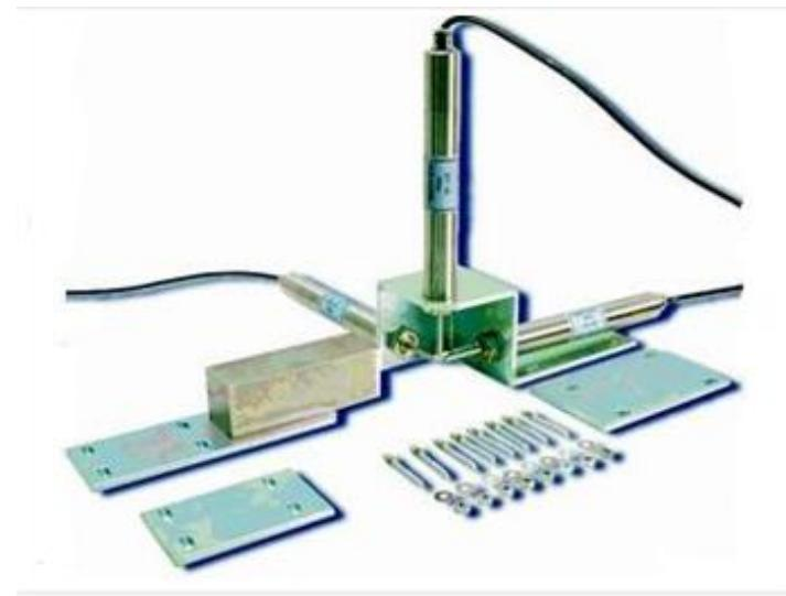
图 7 三向测缝计安装示意
