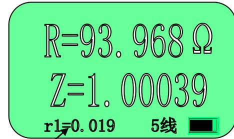
图五 五线制测量界面
