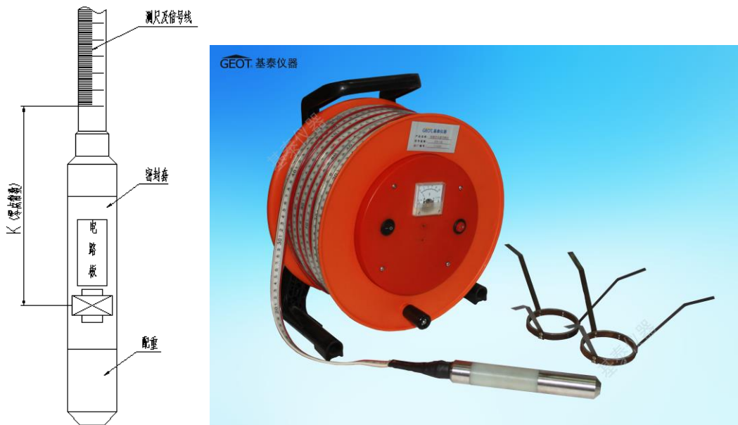
图 1：左图为传感器测头；右图为整机外观
